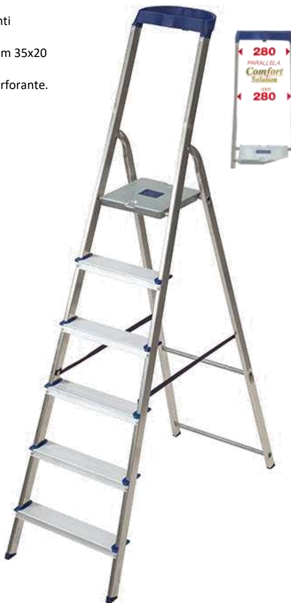
Gradini profondi 120 mm. Fissati ai montanti con tecnica autoperforante
